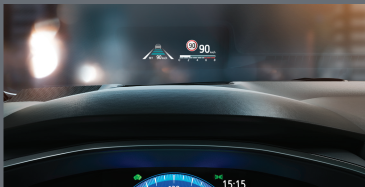
10-дюймовый проекционный дисплей на лобовое стекло
